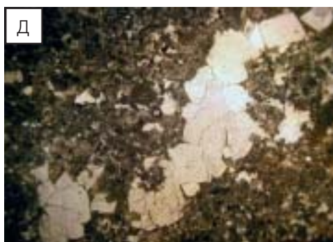
Микрофотографии пород, николи ||. А — известняк с пятнами доломита, ув. 30; Б — доломит замещения, известковистый, ув. 24; В — доломит перекристаллизации, ув. 24; Г — известняк с рассеянными кристаллами и мелкими агрегатами доломита, ув. 28; Д — доломитовые известняки с рассеянными кристаллами и мелкими агрегатами доломита, ув. 35.
